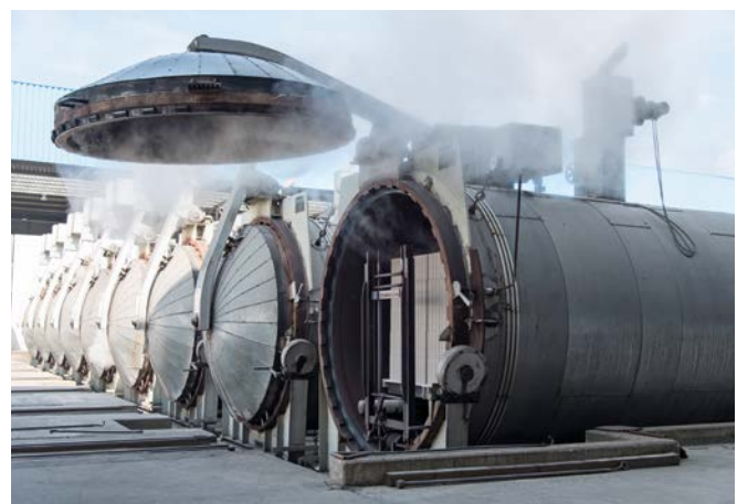
Bild 5 Das Härten der Rohlinge erfolgt in Dampf-Härtekesseln.
