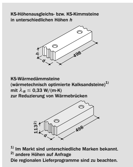
Bild 18: KS-Kimmsteine/KS-Wärmedämmsteine
