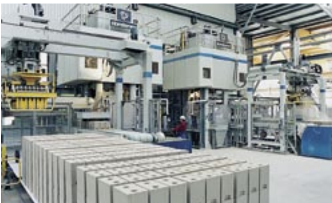
Bild 5: Nach dem Mischen werden die Rohlinge gepresst.
