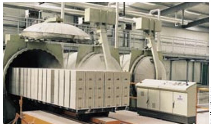
Bild 6: Das Härten der Rohlinge erfolgt in Autoklaven.
